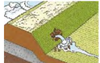
図序-10 漏水（出典：国土交通省HP）
